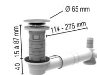
Vidage - Bonde avec tubulure extra-plate
